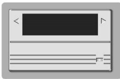
本仪器提供的是 16 行微型面板式打印机，使用寿命长、打印速度快、更换打印纸和色带容易，无须其他维护和保养。整机电源接通后打印机右下角指示灯亮，表示打印机处于待机状态，测试中或测试完毕后根据显示提示按下打印键就可打印出数据。
