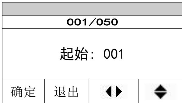
打印之前您需要设置需打印数据的起始序号和结束序号，使用“◀▶”键在序号的各位之间切换，使用“◆”键改变各位的数字大小，设置完成后按“确定”键确认。
