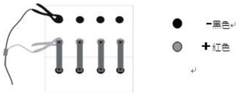
图 3.2.3 极柱测量连接方式
