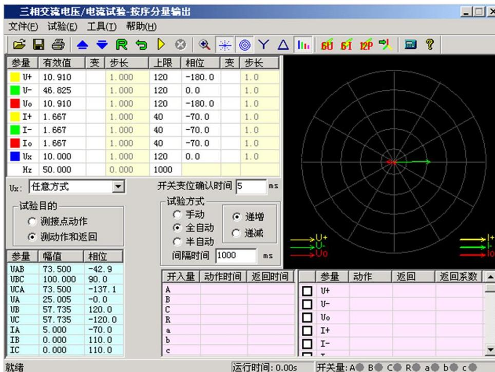
在界面上直接设置需输出的电压电流的各种序分量，不需要象传统的通过设置各相电压电流幅值和相位来得到各序分量，大大简化了操作，甩开了传统的复杂计算，为测试序分量继电器提供了方便。例如，要输出三相负序电压，若在三相交流输出页面，就必须分别设置三相电压的幅值和相位，而现在只需要将所需输出的负序电压值赋予给“U-
