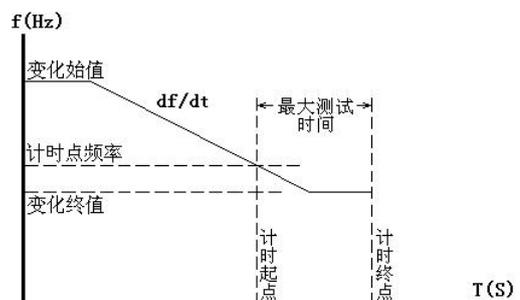
频率”。一般设置为装置整定的动作频率，或测试出的准确动作频率值。
