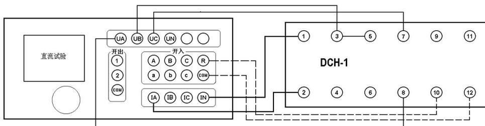
在直流试验中，用手动试验方式，设置  $I_a$  为中间继电器保持电流， $U_{ab}$  为 220V（ $U_a$  为 +110V， $U_b$  为 -110V）作电容充电电压， $U_c$  为 +110V。按下“确认”，“开始”输出 220V 电压。
