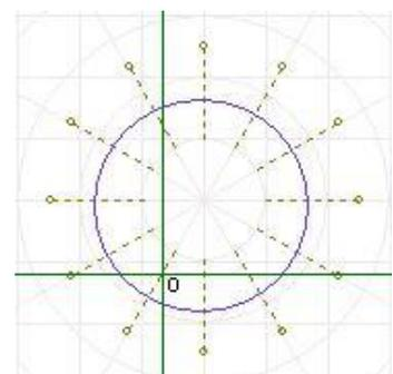
● **搜索角度** 通过设置起始角度、终止角度以及角度步长来设置系列搜索线。如果角度步长设置得很小，虽然搜索出的点很多，有利于提高边界搜索精度，但也会大量增加试验时间，实际测试时请选择适当的角度步长。
