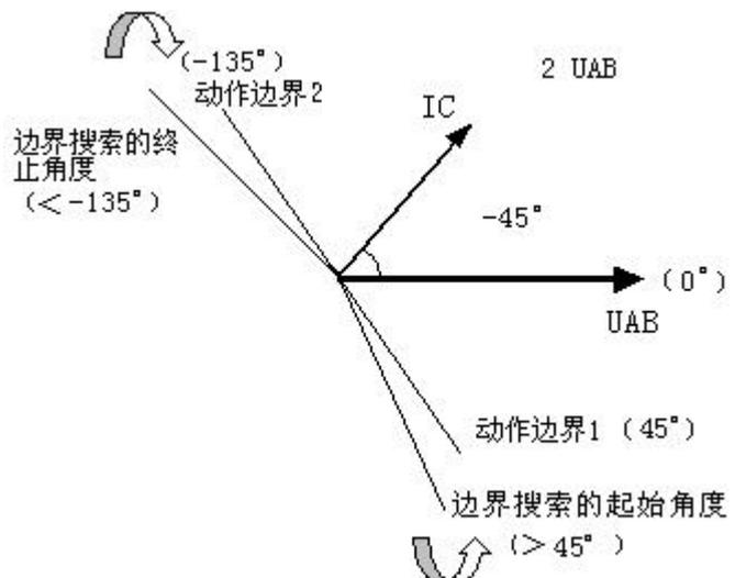
保护的一条动作边界在  $0^{\circ}\sim 20^{\circ}$  之间。用同样的方法找出保护动作的另一条边界的大致范围，假设为  $-130^{\circ}\sim -120^{\circ}$ 。
