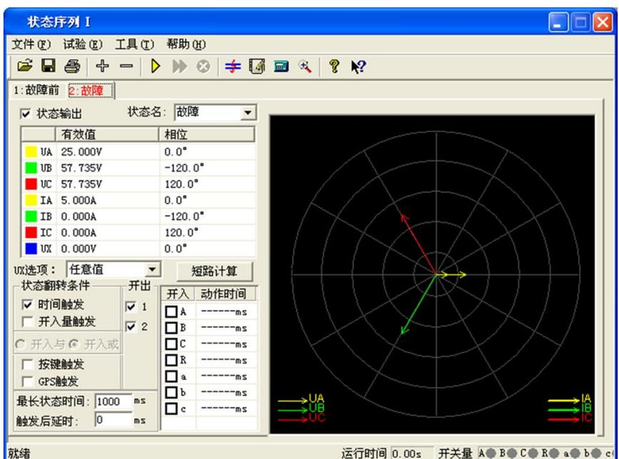
这个状态是整个试验的最后一个状态，也就是后加速状态。模拟的是一个电流后加速故障。对于故障类型的设置就看具体的保护是什么样的后加速故障，就模拟什么样的后加速故障状态。同样选择“开入量触发”状态翻转条件，也就是在接到保护跳闸信号后测试停止。
