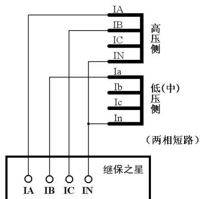
开始试验，差动保护应不动作。按步长降 I C（备注：也可以采用增加变量的方式）至差动保护动作，记录下此时 I C 的值，假设为 I C1。这样，得出了一组数据：高压侧电流为 3A，低压侧为 I C1。
