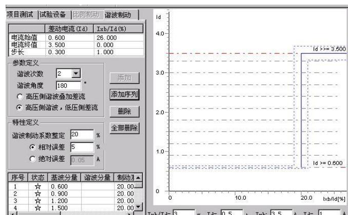
将搜索线数据填入测试数据列表中。选“开始试验”即可进行测试。选“删除”或“全部输出”可以删除搜索线。
