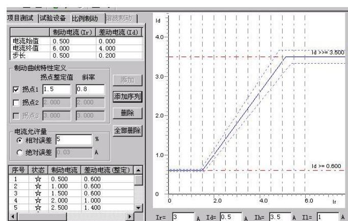
差动电流的始值、终值决定搜索线的长度，一般要求始值略小于差动电流门槛值，终值略大于差动速断值。差动电流步长仅在单向逼近时起作用，在双向逼近方式不起作用。差动电流步长的设置根据保护的要求精度来设置，如果要求精度高我们就把步长设置小些。
