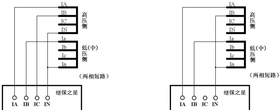
测试仪输出三路电流,  $I_C$  为补偿电流
