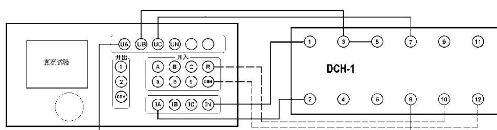
作电容充电电压， $U_c$  为 +110V。按下“确认”，“开始”输出 220V 电压。
