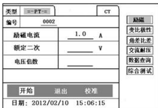
图 28, PT 励磁特性参数设置界面
