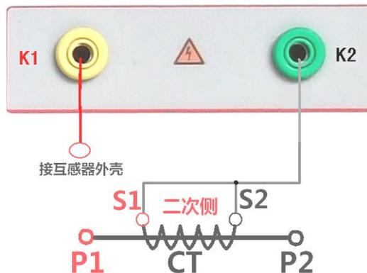
图 20, CT 交流耐压接线图
