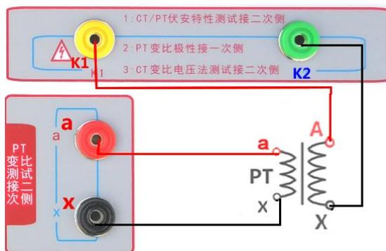
图 31，PT 变比极性（角差比差）接线图
