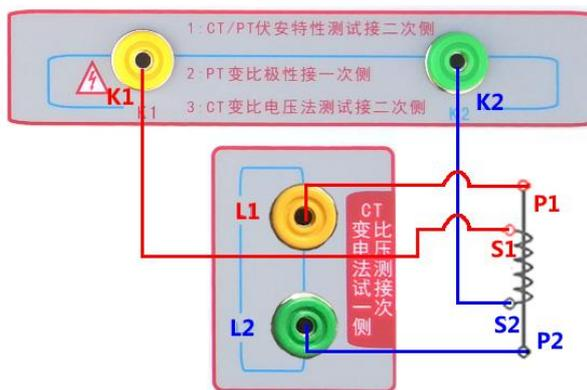
图 14, 电压法 CT 变比极性
