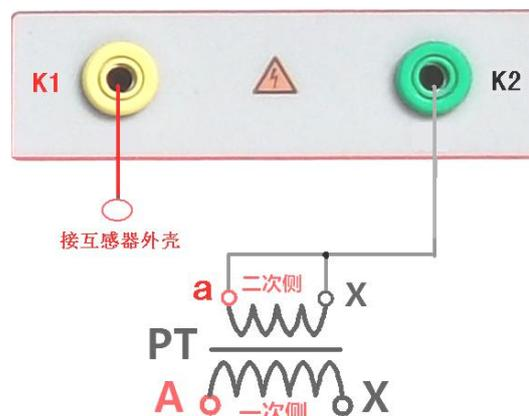
图 35, PT 交流耐压接线图
