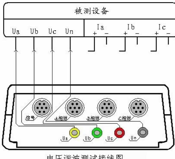
电压谐波测试接线图
