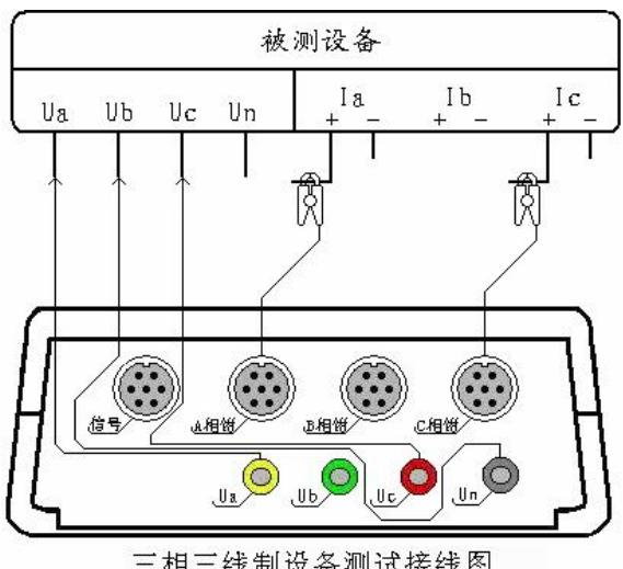
电流互感器用来测量被测设备电流的 A、C 两相，接好线后进入“测试参数”屏查看测量结果。
