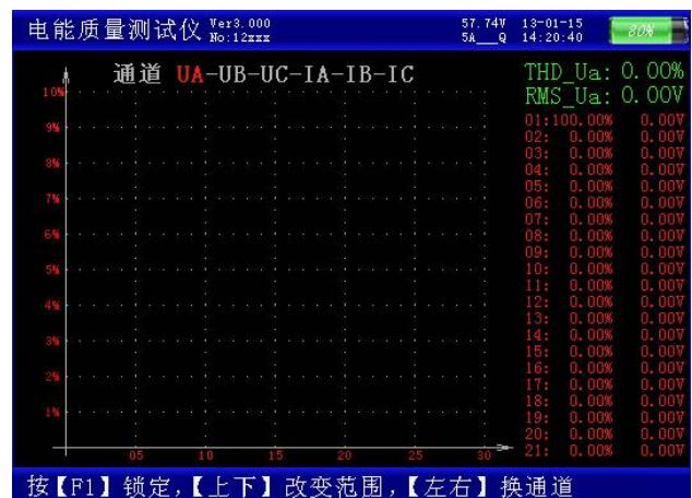
图里只显示到 32 次。 $U_A-U_B-U_C-I_A-I_B-I_C$  提示当前测量通道 (可通过  $\leftarrow$ 、 $\rightarrow$  键来改变所选通道), 纵坐标刻度 0%-10% 表示各次谐波分量的百分比含量, 基波含量始终对应到 100% 刻度 (当所有次数的谐波含量都小于 10% 时进行放大显示, 即以 10% 做为满刻度; 当有一项以上的谐波含量大于 10% 时, 以正常刻度显示, 即以 100% 做为满刻度), 横坐标的指示的是谐波的次数, 右侧数值显示总谐波畸变率 THD、有效值和 1—64 次各次谐波的数值 (用  $\uparrow$ 、 $\downarrow$  键来翻页)。无失真的信号应显示第一次谐波 (基波)。测试时用  $U_a$ 、 $U_b$ 、 $U_c$  三个电压通道和  $I_a$ 、 $I_b$ 、 $I_c$  三个电流通道进行测量。
