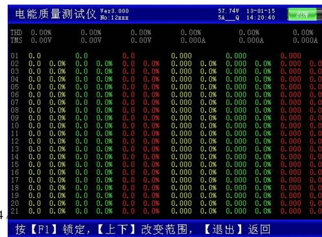
波失真度), RMS 为各相的电压或电流有效值, 01 次为基波电压或电流 (用实际幅值表示), 以下依次为其它各次谐波的数值, 以有效值形式和基波的百分比两种形式表示, 以表格的形式显示 1-63 次谐波。可通过  $\uparrow$ 、 $\downarrow$  键来切换 (01—21) 次、(22—42) 次 (43—63) 次谐波含量的表格。
