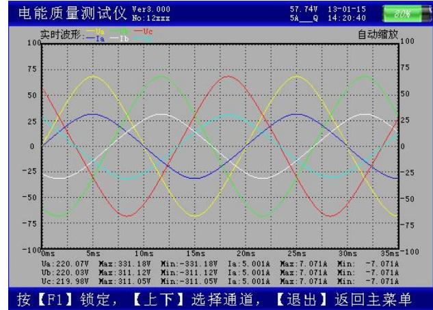
B 相电压、电流的波形，C 相电压、电流的波形，A、B、C 三相电压的波形，A、B、C 三相电流的波形。可以做为简单的示波器使用。
