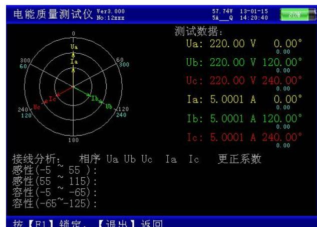
容、感性关系，上图所示为标准阻性负载时接线全部正确情况下的三相四线向量图。按 F1 键能将屏幕锁定，便于读数，按 F2 继续刷新。按 F3 键返回主菜单。
