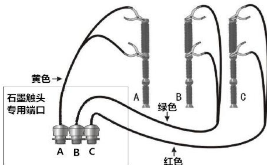
图 13 石墨触头三断口接线图
