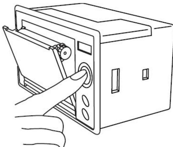
图 16 打开前盖操作示意图
