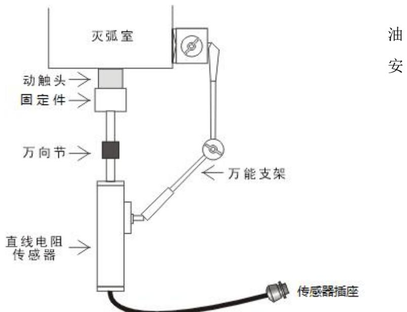
图 15 行程传感器安装示意图
