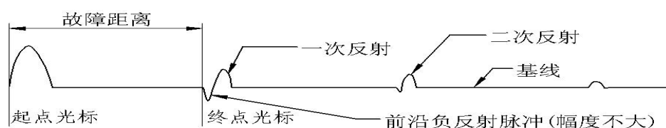
图 21 闪络法电流取样测试波形
