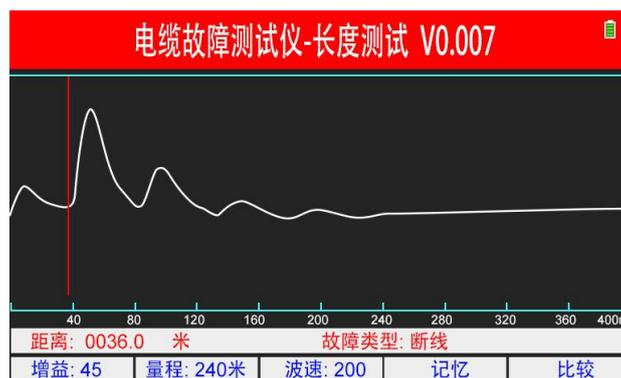
断线波形是往上凸起的，故障波形一定是图上最大的那个波形。
