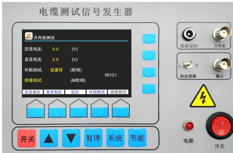
在探测之前，要弄清故障线的性质。把连接线接到信号发生器万用表端口，按屏幕上对应的万用表按键通过测量绝缘电阻等指标把故障性质及故障线判定出来。
